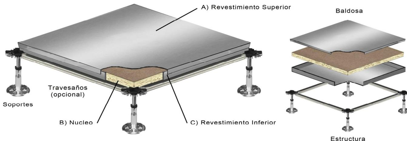
**Revestimiento superior e inferior:** formado por una **bandeja de acero** laminado en frío, bajo en carbono para embutición o conformado en frío (UNE 36-086-91 ó EN 10130), protegida con un recubrimiento galvanizado de zinc que le confiere una elevada protección contra la corrosión. Este producto puede solicitarse con conductividad eléctrica.
